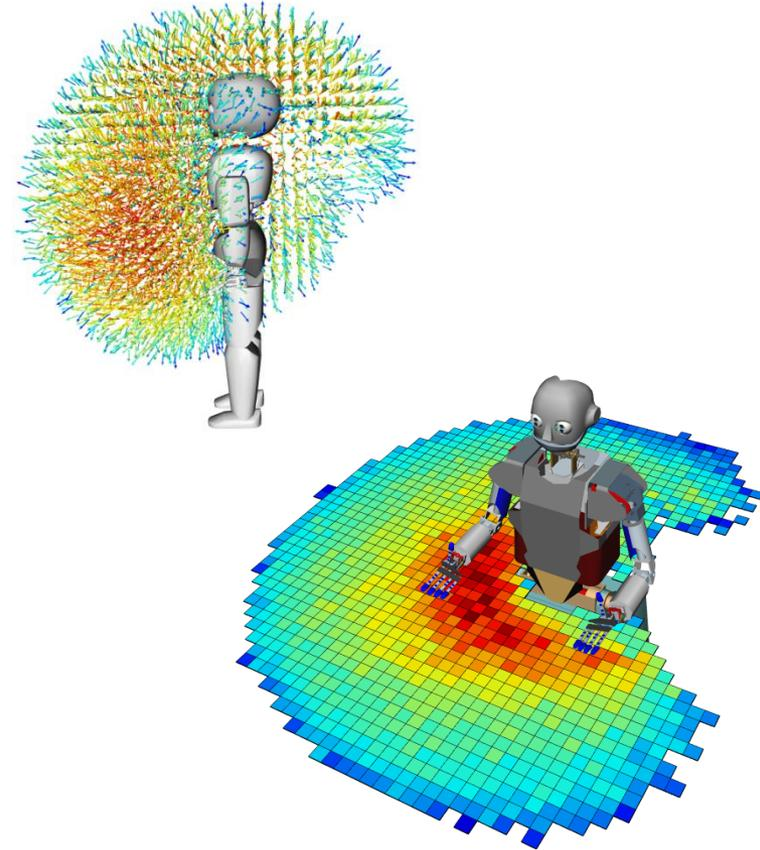
Visualisierung der Erreichbarkeit bzw. Manipulierbarkeit für die Roboter iCub und Armar-III
